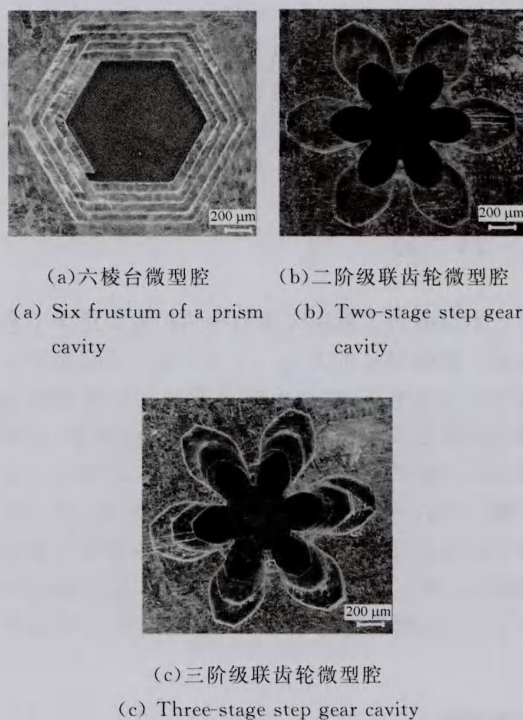
图8 三维微模具加工结果
